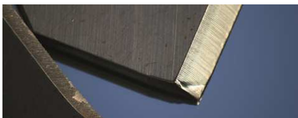
Pretratamiento efectivo de bordes cortados por láser. Fuente: BBM Laseranwendungstechnik GmbH
